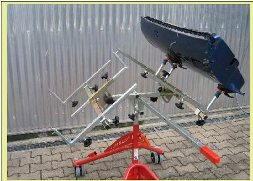
Das dreifache Saugfuss-System garantiert eine rasche und sichere Aufnahme von Fahrzeugteilen wie z.B. Türen, für Karosserie-, Montage- und Lackierarbeiten (auch von sehr stark gewölbten Türen, wie hier siehe Abb. ) und kann stufenlos von senkrecht in waagrecht gestellt werden.
