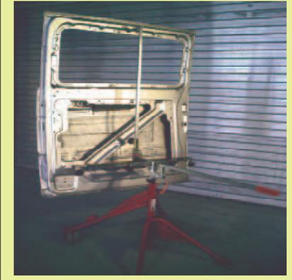
**Auf dem Multifunktionsständer bearbeiten Sie Motorhauben, Stoßfänger, Heckklappen, Türen und Hardtops aller Fabrikate in stufenloser Neigung von waagrecht bis senkrecht und höhenverstellbar.**
