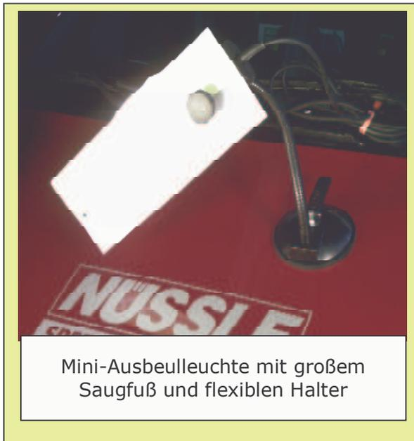
Mini-Ausbeulleuchte mit großem Saugfuß und flexiblen Halter
