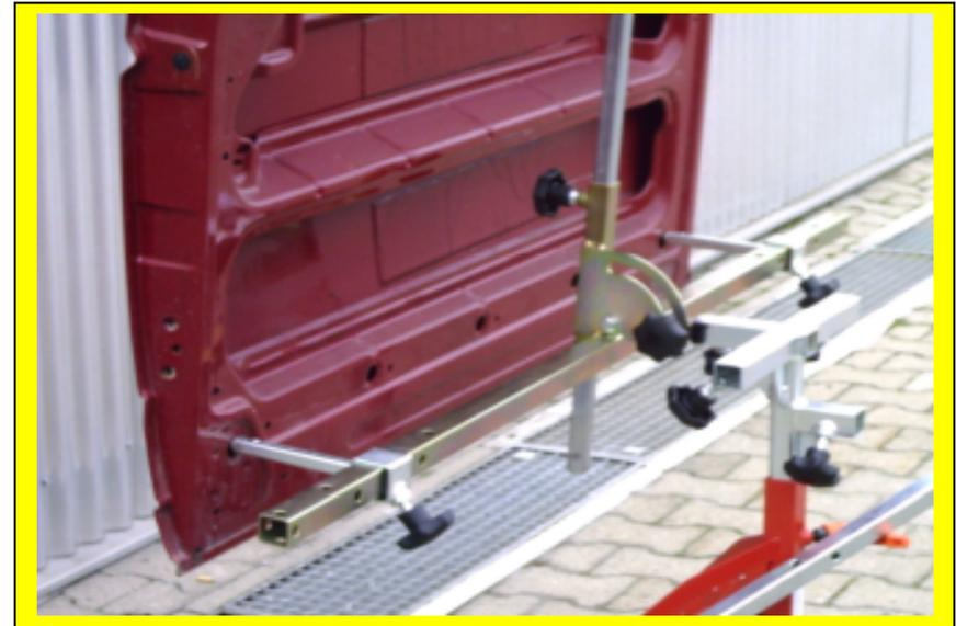
Breit, sicher, standfest und rationell bearbeiten Sie jetzt auf dem überbreiten Multi-Ständer mit einer max. Ausladung bis zu 1,60 Meter breite Schiebetüren und Klappen, wie z.B. Mercedes Sprinter, Vito und ähnliche Größen.
