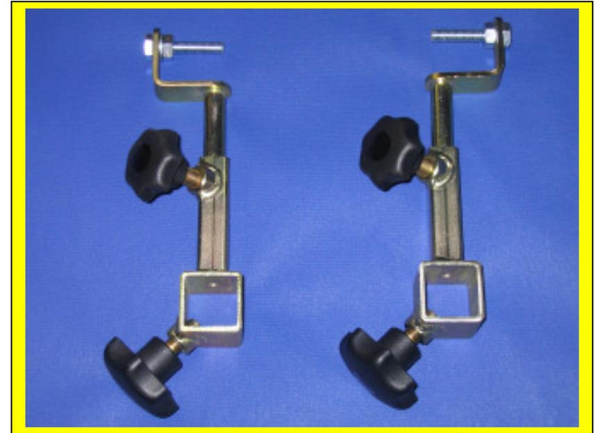
**Die Türenaufnahme am Lackierständer kann sowohl durch 2 Schrauben als auch durch 1x schrauben und durch einsetzen eines Gewindestiftes im Drehgelenk ( Tür wird nur aufgesteckt ) erfolgen. In beiden Fällen können beide Türen um 90 Grad geschwenkt und in der Höhe angepasst werden.**
